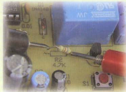
Figura 2.27. Midiendo una resistencia sobre un circuito con una extrema desconectada
